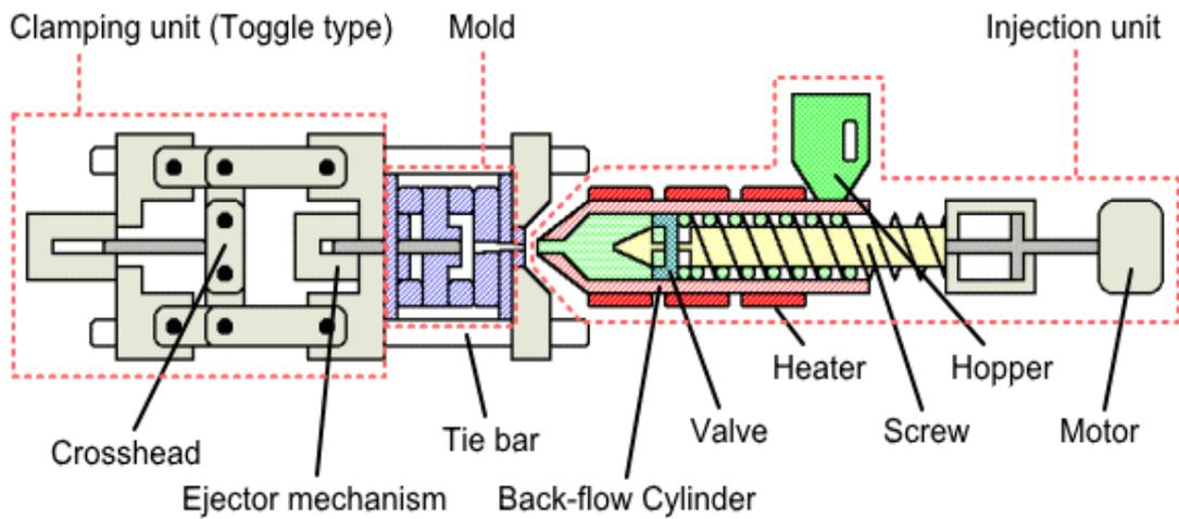
TYPICAL INJECTION MOULD
